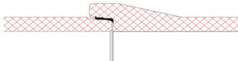
Sl. 3.17. Prikaz načina montaže- spajanja cijevi
