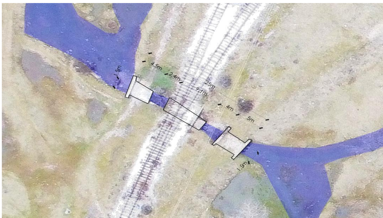
Sl. 3.4. Propust ispod pruge (sjeverna strana)
