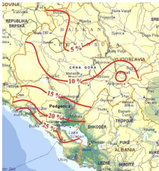
Slika 2.9. Mapa seizmičke opasnosti za povratni period od 100 godina, sa parametrom očekivanog maksimalnog horizontalnog ubrzanja ( a % g ) i sa vjerovatnoćom od 63%
