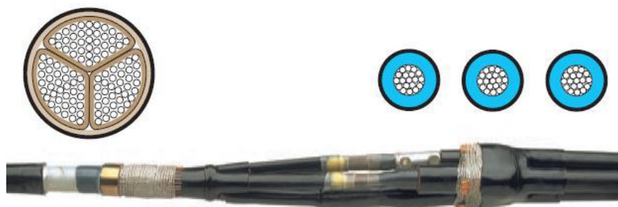
Slika 3-4: Prelazna spojnica za spajanje kablova izolovanih plastičnom masom na 3-žilne pojasne ili ekranizovane kablove izolovane papirom i sa zajedničkim metalnim omotačem
