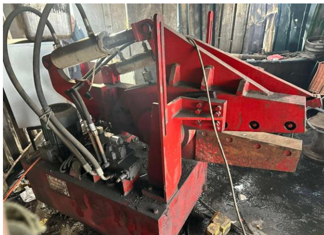
Slika 21. Elektrohidraulične makaze za odsijecanje metalnih djelova
