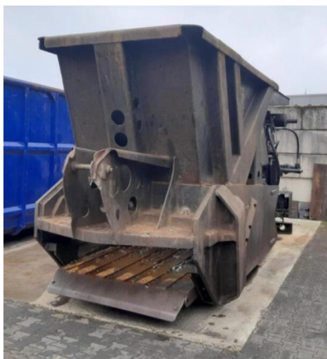
Slika 24. Mobilne makaze za usitnjavanje habastih metalnih limova
