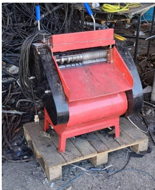
Slika 22. Električna mašina za guljenje kablova
