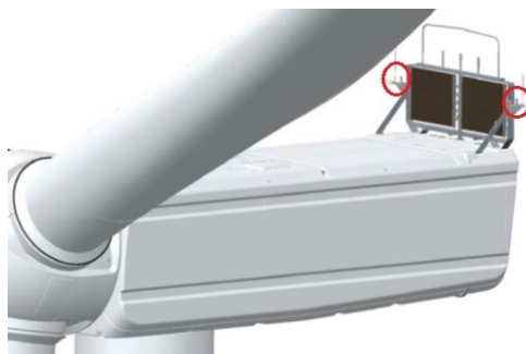
Slika 3.3. Položaj svjetiljki za obilježavanje VA kao prepreke u vazduhoplovstvu
